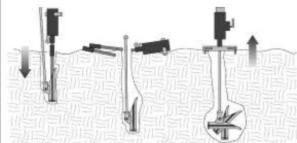
Slika 10: Princip upucavanja i zaključavanja Manta Ray® sidra u dno s primjenom hidrauličnog čekića (izvor: <http://www.abcdiving.com/>)
