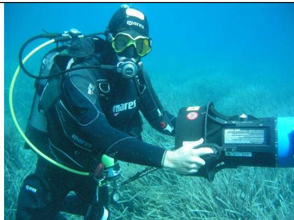
Slika 16. Ronilac s podvodnim skuterom i koloturom za namatanje plutače s GPS-om
